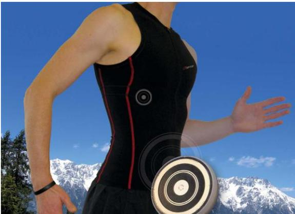
Le système est intégré à un T-Shirt avec des électrodes-capteurs sèches qui mesurent l'activité électrique du cœur, le taux d'oxygène dans le sang et la température interne. Les données sont stockées et transmises sans fil.
